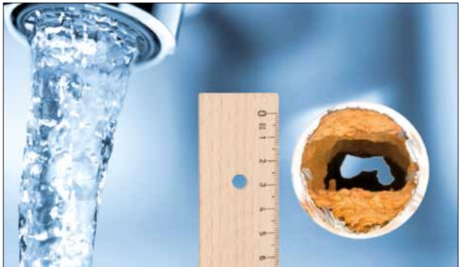
Das muss nicht sein! Kalkablagerungen und Rost können Trinkwasserleitungen verengen, ohne dass der Hausbesitzer es merkt. Im schlimmsten Fall kommt es zum "Rohrinfarkt".
